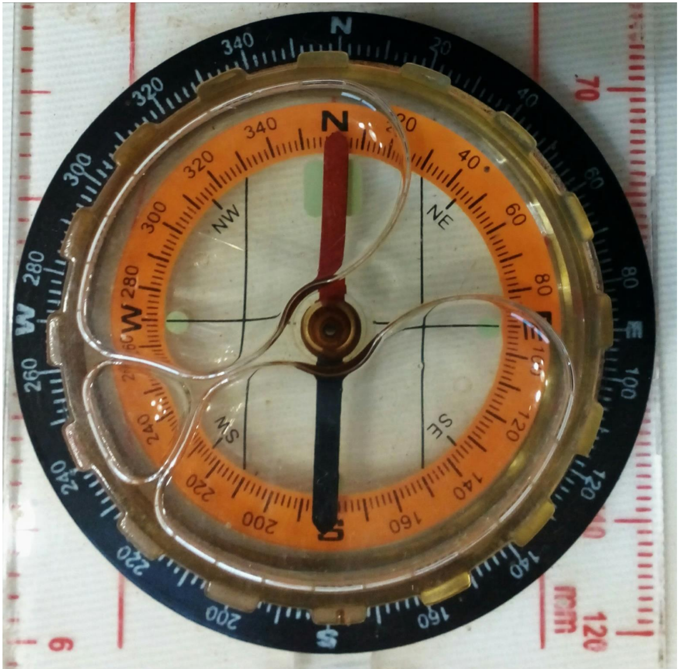
Grados de Azimut en una brújula o teodolito. Obsérvese el nivel de burbuja.
