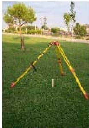
Trípode excesivamente abierto
