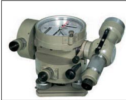
Fig 4: Brújula topográfica taquimétrica Fig 5: Estación total con puntero laser
